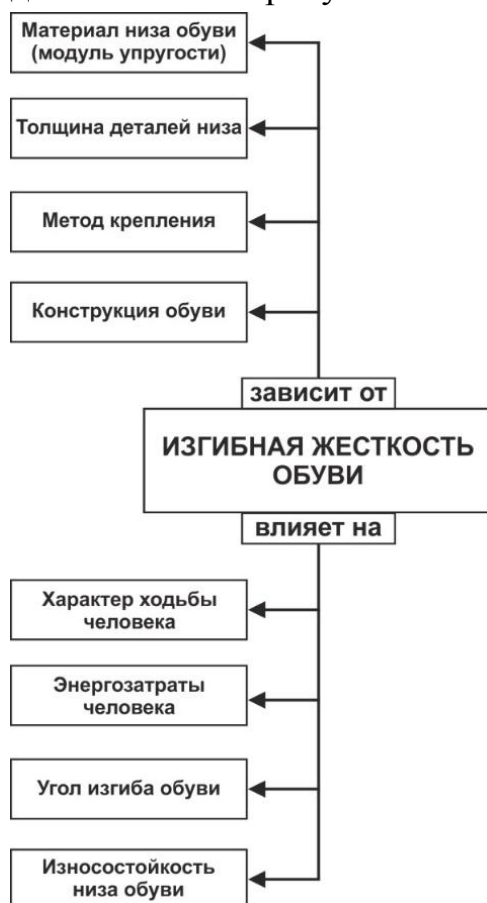
Рисунок 4. Факторы, определяющие изгибную жесткость обуви
